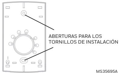
Fig. 3 Cubierta de la placa frontal no instalada.
